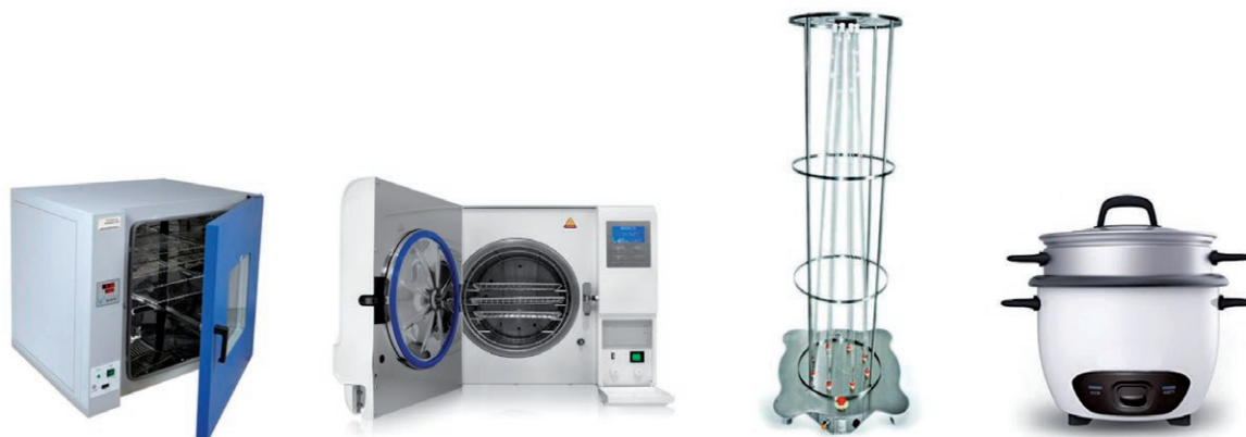
Figura 3. Equipos usados en la descontaminación. (A) horno esterilizador, (B) autoclave, (C) torre con bombillas UV, (D) vaporizador casero.
