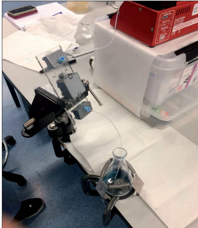
Figura 5. Sistema de flujo laminar, bloques conectores y canal incorporado.
